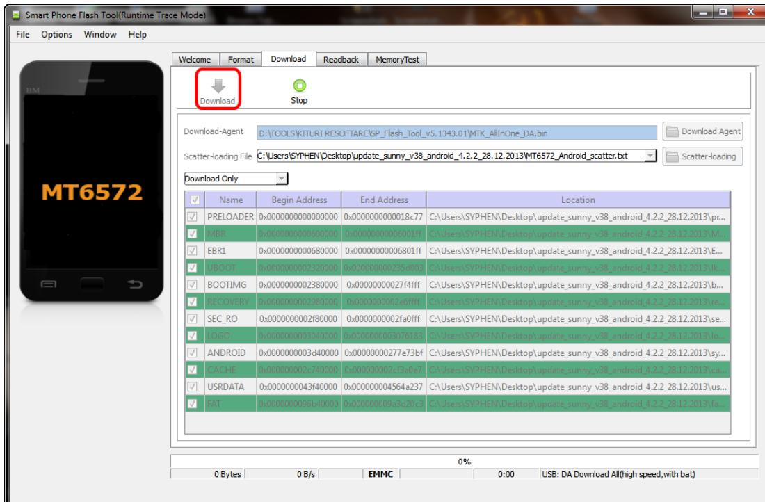
7. Introduceti cablul USB conectat la PC in tableta, procesul de update va porni automat,
